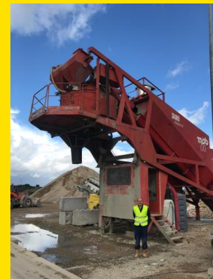
Centrale à béton
